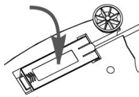
3. Installare il modulo di interfaccia.
