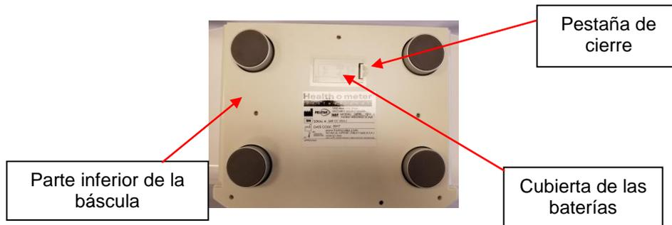
2. Reemplace las baterías o instale nuevas baterías de 9V. Health o meter® Professional recomienda usar baterías alcalinas o de litio, clasificada para funcionar a 130 ° F (54 ° C). No use baterías de zinc-carbono. Vuelva a colocar la cubierta del compartimento de las baterías.
